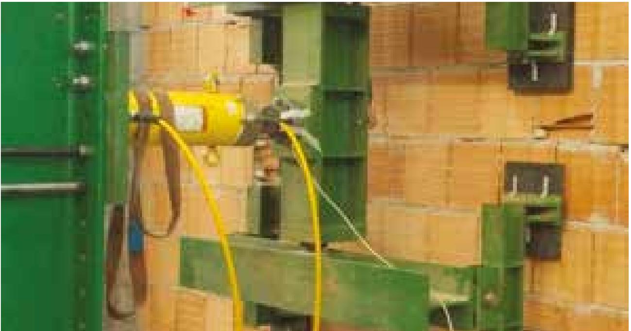
Particolare del sistema per l'applicazione del carico
