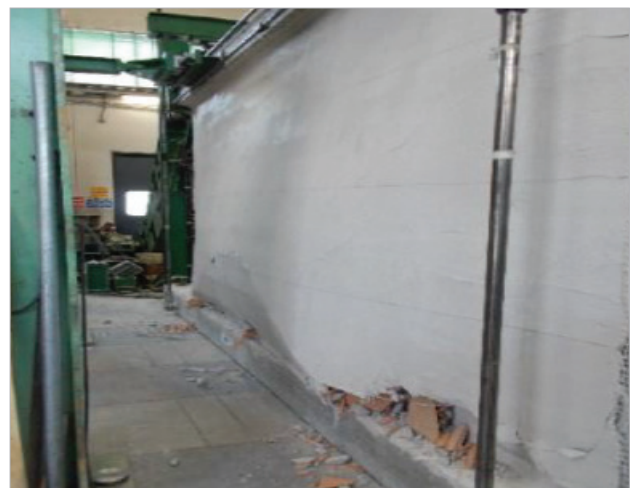
Fine prova della muratura rinforzata
