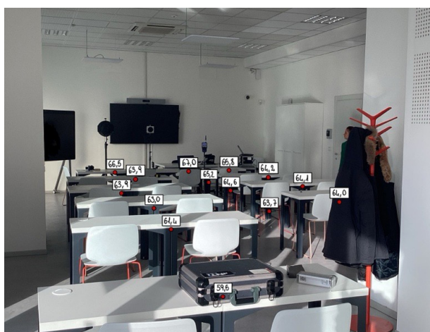
Schema del posizionamento dei punti per la caratterizzazione qualitativa della distribuzione sonora nell'ambiente: nella foto a sinistra 14 punti di SPL in dBA, nella foto a destra 14 punti di STIPA.
