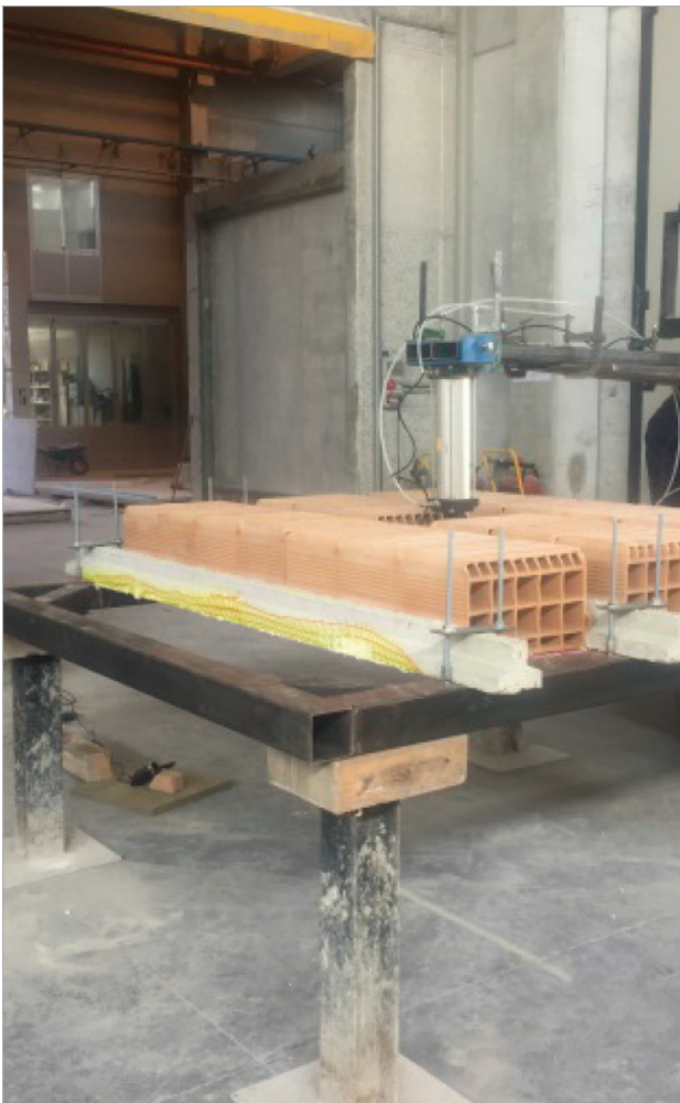
Solaio in latero-cemento - Strumentazione di prova
