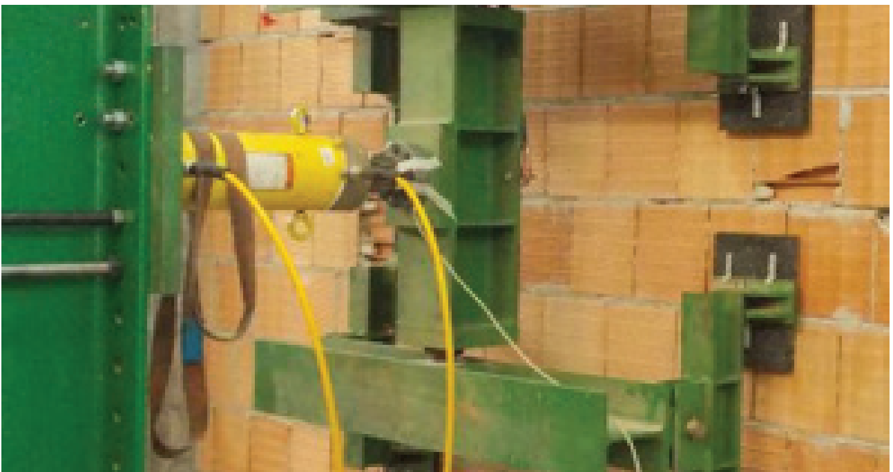
Particolare del sistema per l'applicazione del carico
