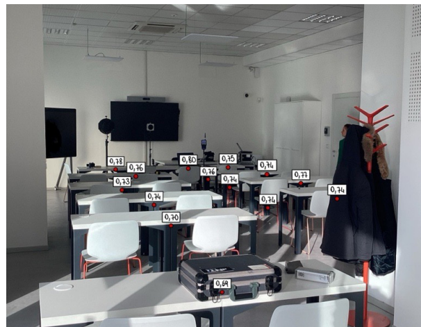
Schema del posizionamento dei punti per la caratterizzazione qualitativa della distribuzione sonora nell'ambiente: nella foto a sinistra 14 punti di SPL in dBA, nella foto a destra 14 punti di STIPA.
