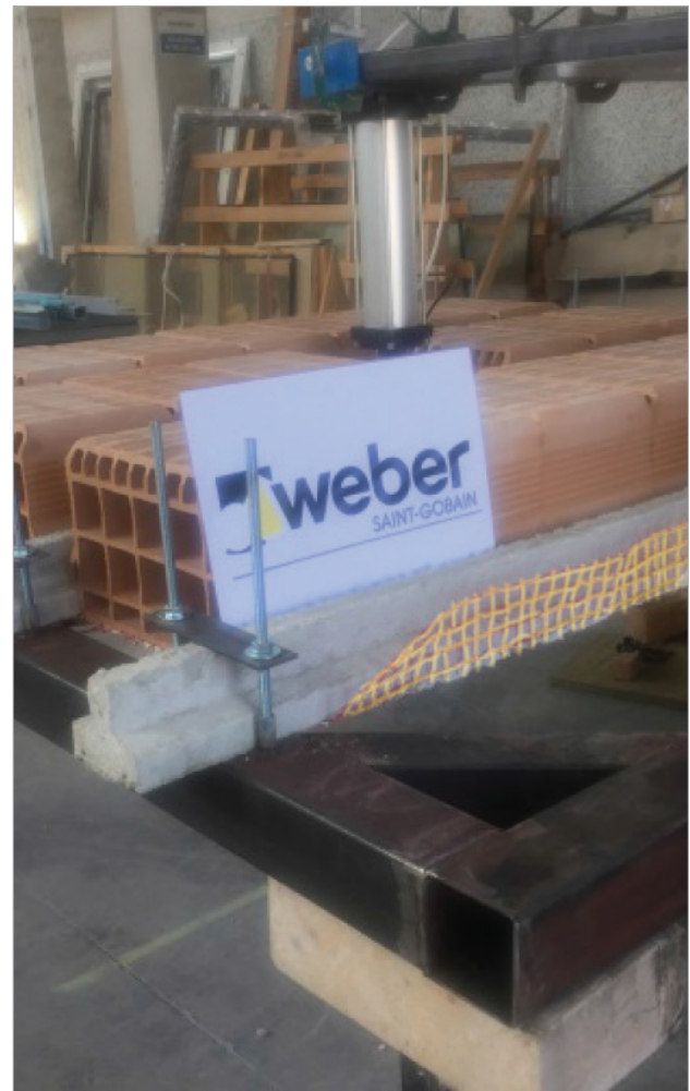
Solaio in latero-cemento - Strumentazione di prova
