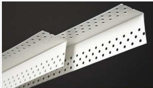
Aquabead è un paraspigolo facile da applicare, autoadesivo, per angoli da 90°. È realizzato in carta microforata con anima in PVC, la cui faccia interna è rivestita con un adesivo che si attiva con della semplice acqua, garantendo una perfetta aderenza. I fori sulla superficie permettono allo stucco di far aderire perfettamente il paraspigolo alla parete.
