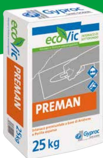
Intonaco premiscelato a base di anidrene e Perlite espansa di speciale granulometria, inerte calcareo selezionato ed additivi specifici Trova applicazione come intonaco per interni tipo bistrato e quindi richiede per la sua finitura liscia speculare l'applicazione di un sottile strato di scagliola o rasante a presa avvenuta.
