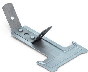
Il gancio con molla viene utilizzato nella costruzione di controsoffitti per il montaggio dei profili Gyprofile a C 27/60. Viene prodotto mediante stampaggio di lamiera di metallo zincato laminato di spessore 0,80 mm e di una clip a molla singola che viene premuta nel gancio con due rivetti. L'inserimento nell'orditura metallica primaria avviene per rotazione verticale, posizionando l'accessorio all'interno della C del profilato.
