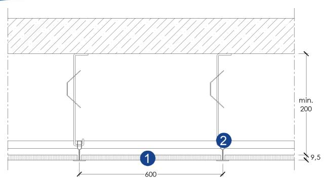
Controsoffitto modulare ispezionabile in pannelli di gesso rivestito Gyproc CS.P GyQuadro A1, di dimensioni 600x600 mm, costituito dagli elementi sottoelencati:
