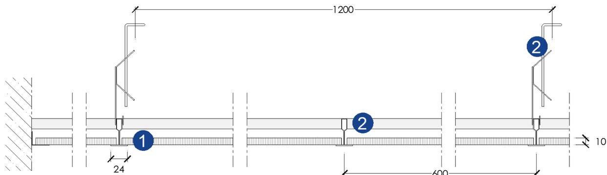
Controsoffitto modulare ispezionabile in pannelli di gesso rivestito CS.P Gyprex® Alba costituito dagli elementi sottoelencati:
