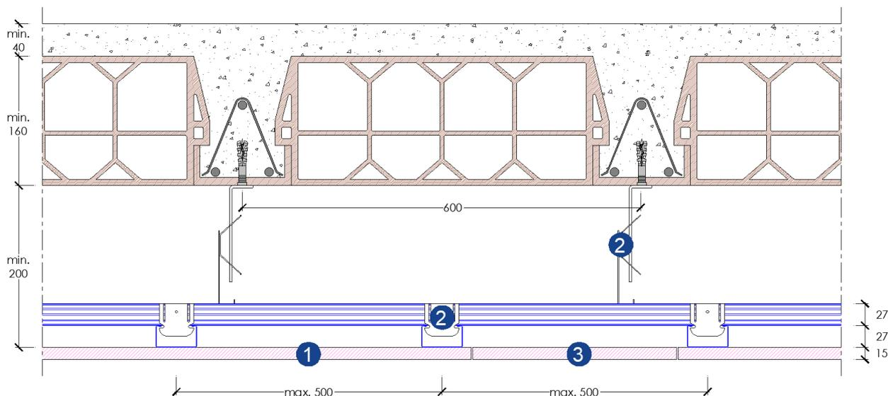
Controsoffitto Gyproc CS.AN. 27/48 15 F su solaio in laterocemento dello spessore di 160 + 40 mm e intradosso non intonacato, costituito dagli elementi sottoelencati:
