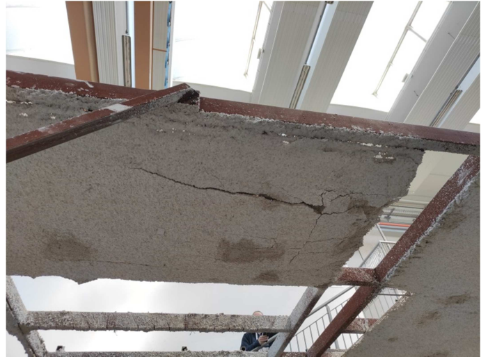
Fotografia dell'intradosso dopo il primo impatto zona di prova "A 1 "
