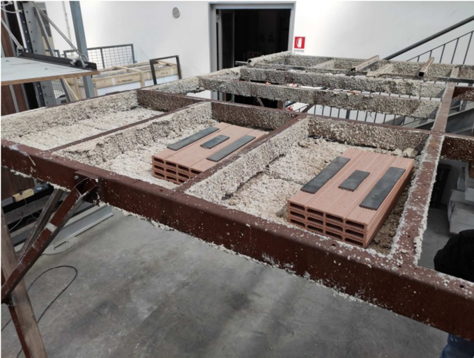
Fotografia dell'estradosso dopo il primo impatto zona di prova "A 1 "
