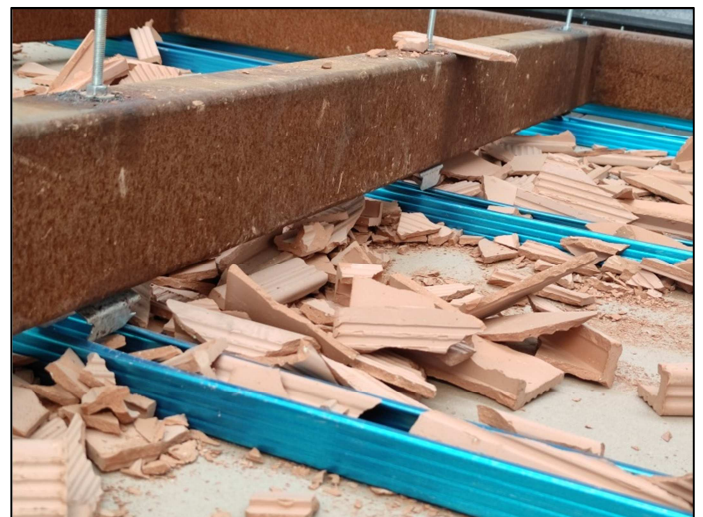
Impatto n. 6 - Cavallotti sganciati visibili dopo lo scarico
