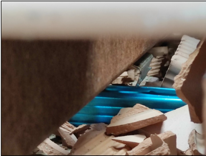
Impatto n. 6 - Particolare di un cavallotto sganciato
