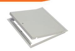
Prodotto costruito in acciaio zincato spessore 0,8 mm a norma EN 10143 ed EN 10346, laccato bianco RAL 9016, da utilizzarsi come elemento di finitura e tamponamento removibile, per permettere l'ispezionabilità delle pareti in cartongesso con spessore del paramento da 12,5 a 25 mm. Il fissaggio alla parete avviene per accoppiamento tra lastra e botola, mediante le apposite linguette metalliche. Per aprire lo sportello si inserisca e ruoti la chiave ad impronta quadrata nell'apposito inserto.
