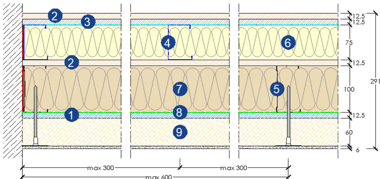
Parete di tamponamento esterno Gyproc SAD4 291/100-75 L GX DG CLIMA dello spessore totale di 291 mm circa costituita dagli elementi sottoelencati:
