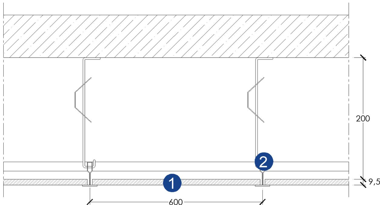
Controsoffitto modulare ispezionabile in pannelli di gesso rivestito Gyproc CS.P GyQuadro Activ'Air®, di dimensioni 600 x 600 mm, costituito dagli elementi sottoelencati:
