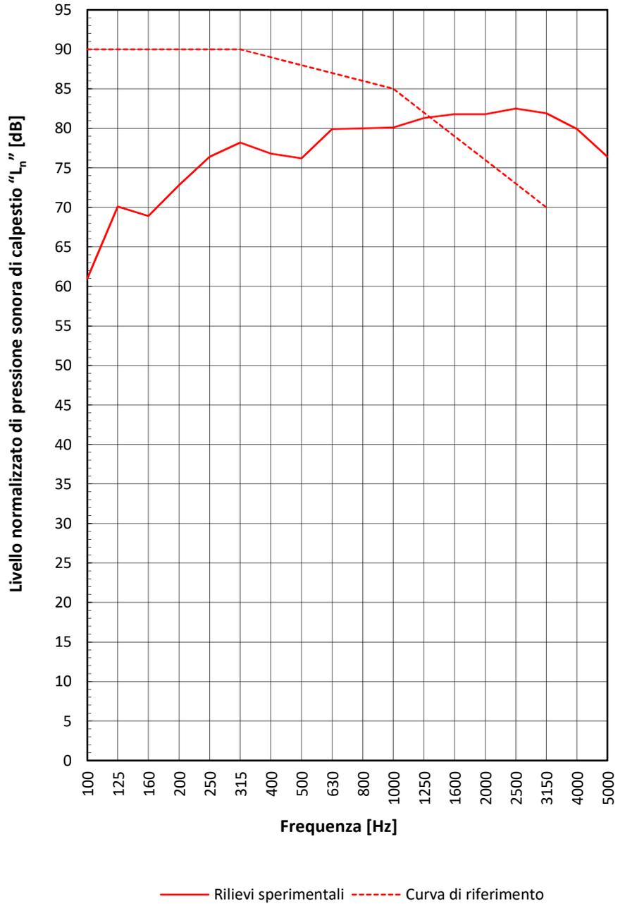
**LIVELLO NORMALIZZATO DI PRESSIONE SONORA DI CALPESTIO DEL SOLAIO CON CONTROSOFFITTO**
