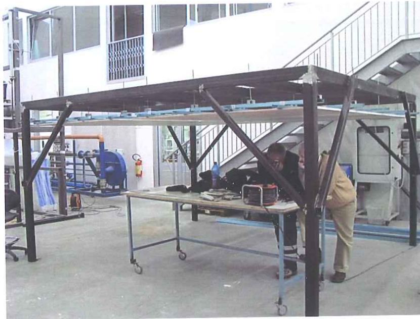
Struttura metallica di sostegno e campione allestito prima della prova.
