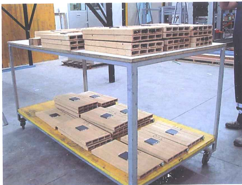
Fotografia degli elementi tavella-piastra allestiti per la prova di antisfondellamento.
