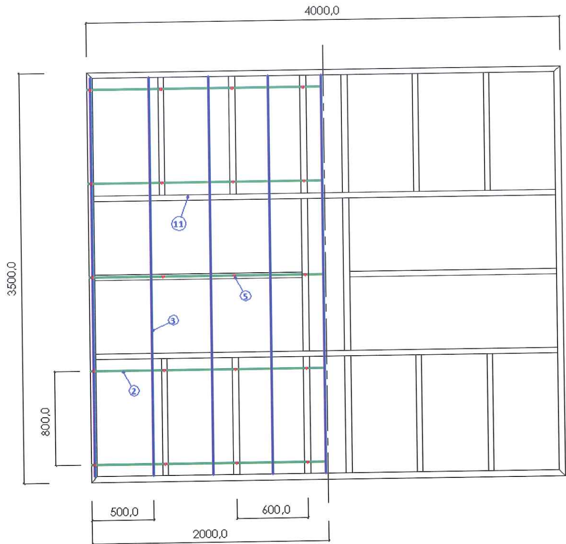
Planimetria: estradosso del controsoffitto.
