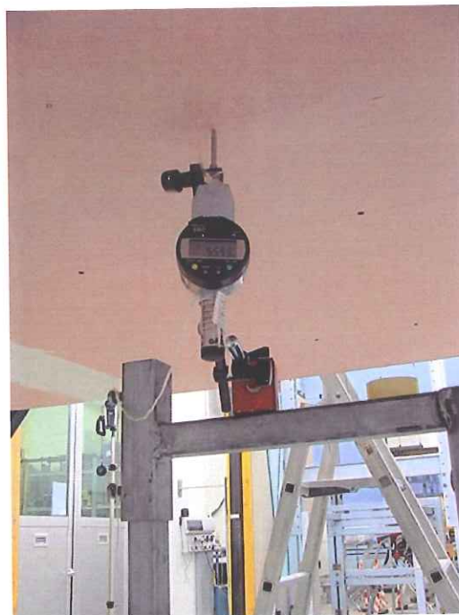
Fotografie del comparatore digitale durante la prova.
