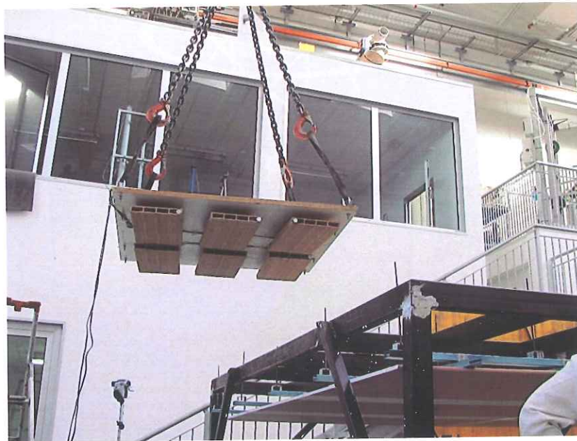
Posizionamento del sistema di carico sul campione in prossimità dell'area d'impatto.
