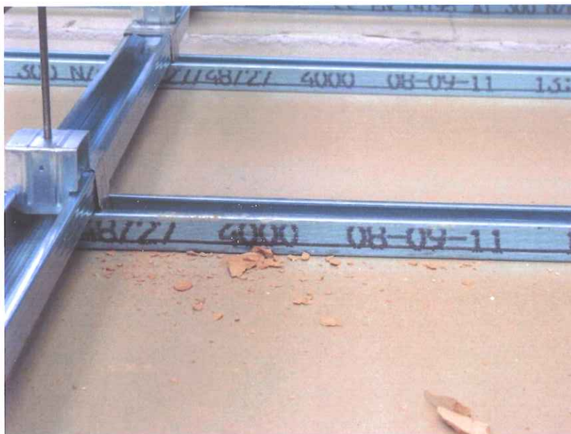
Fotografia della faccia superiore del campione dopo aver rimosso i carichi impattanti.
